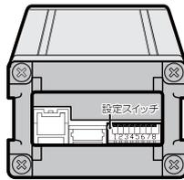
設定スイッチNo.1～No.4をアルパイン2ダイレクトコード用に合わせて設定してください。(下図参照)
