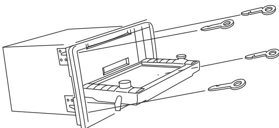
オープンボタンを押し、ディスプレイをオープンさせてから、本製品に同梱のオーディオリースキーを使用して4ヶ所のロックを解除し、ディスプレイユニットを手前に引き抜き、アンテナコネクター、オーディオコネクターを外してからディスプレイユニットを取り外します。
