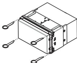
本製品と同梱のオーディオリリースキーを挿入します。2DIN スプリングブラケットのロック部分を4ヶ所解除し、手前に引き出します。
