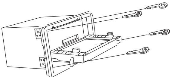
オープンボタンを押し、ディスプレイをオープンさせてから、本製品と同梱のオーディオリリースキーを使用して4ヶ所のロックを解除し、ディスプレイユニットを手前に引き抜き、アンテナコネクタ、オーディオコネクタを外してからディスプレイユニットを取り外します。
