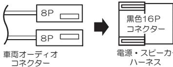
付属のショートコネクタで車両のコードに接続します。
