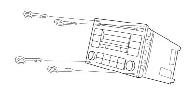
本製品に同梱のオーディオリリースキーにて4ヶ所のロックを解除し、純正オーディオユニットを手前に引き抜き、アンテナコネクター、オーディオコネクターを外してから純正オーディオユニットを取り外します。
