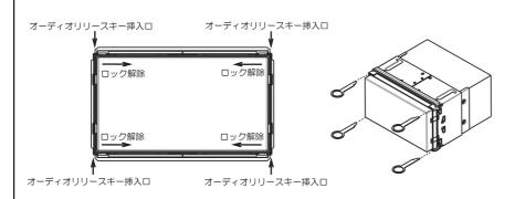
本製品に同梱のオーディオリリースキーを挿入します。 スプリングブラケットのロック部分4ヵ所を解除し、 手前に引き出します。
